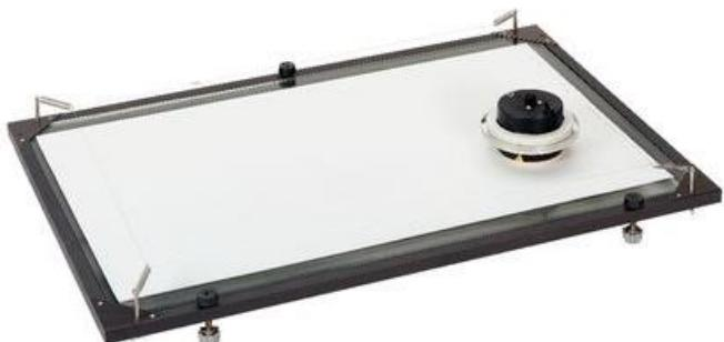
On peut aussi lancer un mobile sur un banc à coussin d'air horizontal.
